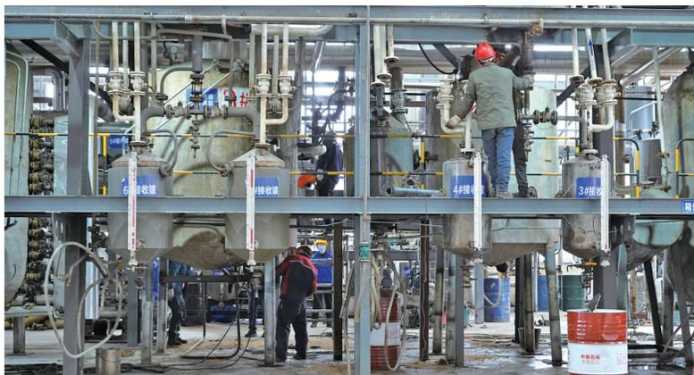
图为工人正在贵州柏森香料有限公司安装新的大型分馏塔
