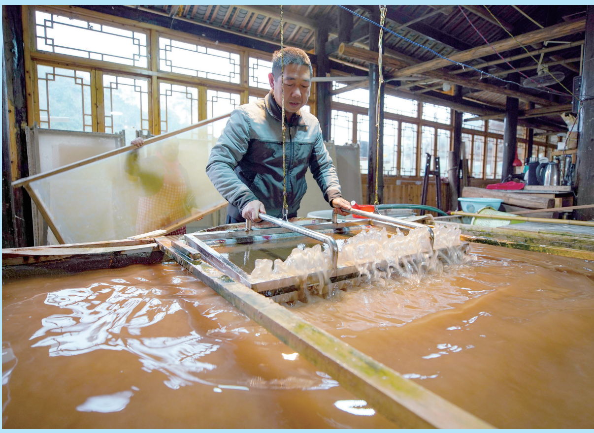
临近年终,在丹寨县南皋乡石桥村,国家级非遗生产性保护示范基地石桥古法造纸作坊的工匠们迎来古籍修复纸、皮纸等订单产品生产旺季,工匠们加班加点抄纸、晾纸、烘纸、揭纸,精心赶制手工纸产品供应市场,作坊里一派繁忙的生产景象。
