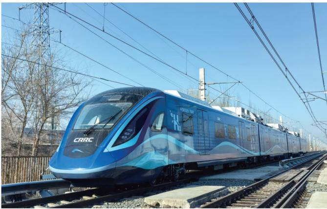
2024年3月21日拍摄的我国首列氢能源市域列车在位于长春的中车长客试验线进行运行试验。(新华社发 中车长客股份公司提供)
