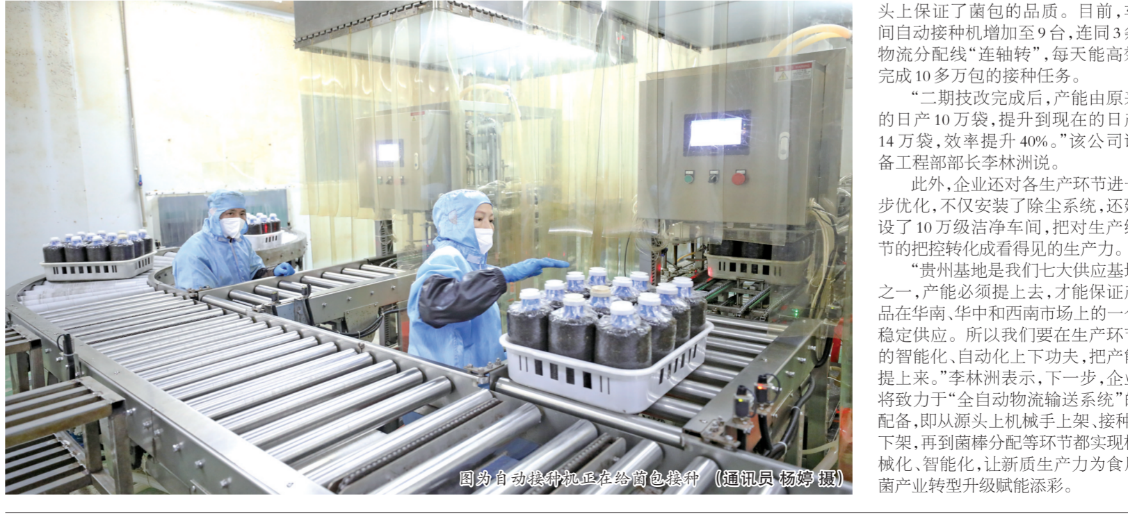
图为自动接种机正在给菌包接种 (通讯员 杨婷 摄)
