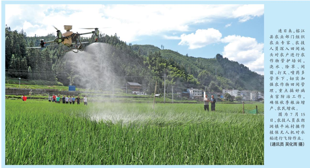
连日来,榕江县农业部门组织农业专家、农技人员深入田间地头对农户进行农作物管护培训,浇水、除草、间苗、打叉、喷药等管齐下,切实加强农作物田间管理,重点搞好病虫害防治工作,确保秋季粮油增产、农民增收。图为7月15日,农技人员在朗洞镇平地村操作植保无人机对水稻进行飞防作业。(通讯员 吴化雨 摄)
