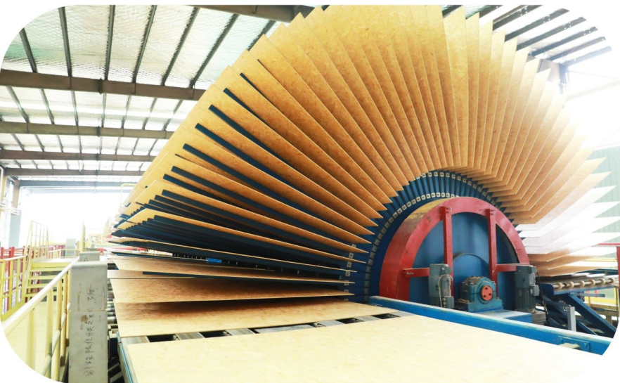
生产线上的自动晾板架 (杨家孟 摄)
