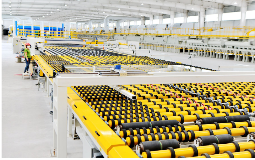
海生玻璃公司日熔化量700吨浮法玻璃生产线
